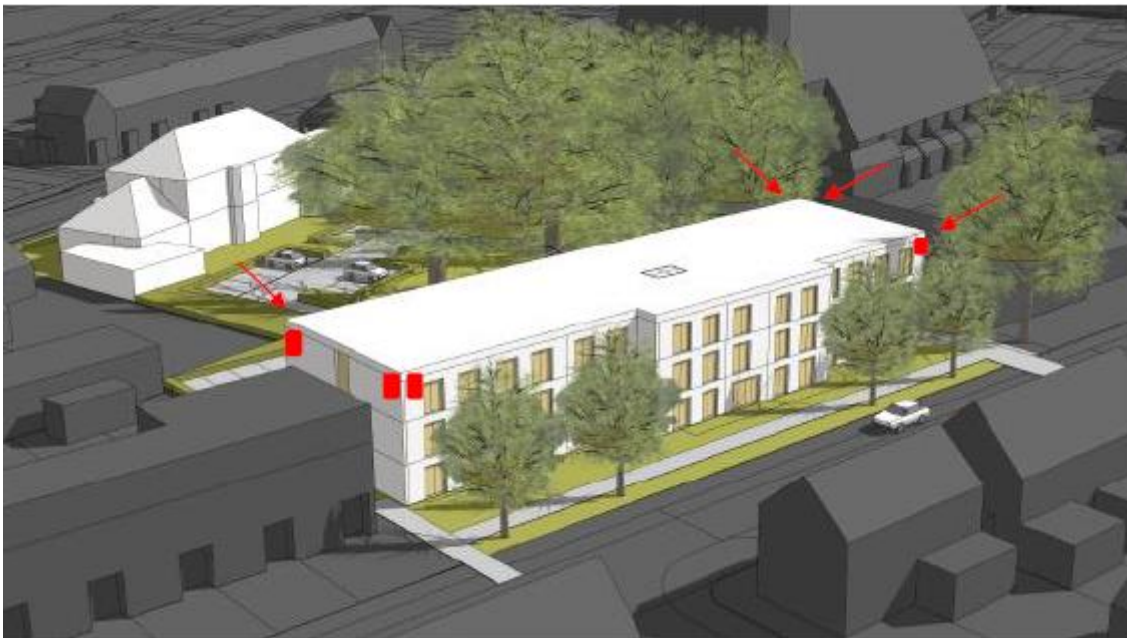
Figuur 3. Locaties van de permanente voorzieningen, acht inbouwstenen, zie rode pijlen, in het gebouw aan de Alard du Hamelstraat 31.
