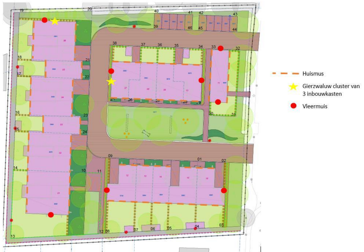
Figuur 3. Locatie van de permanente voorzieningen. De kleine rode stippen zijn locaties waar openbare verlichting aanwezig zal zijn.
