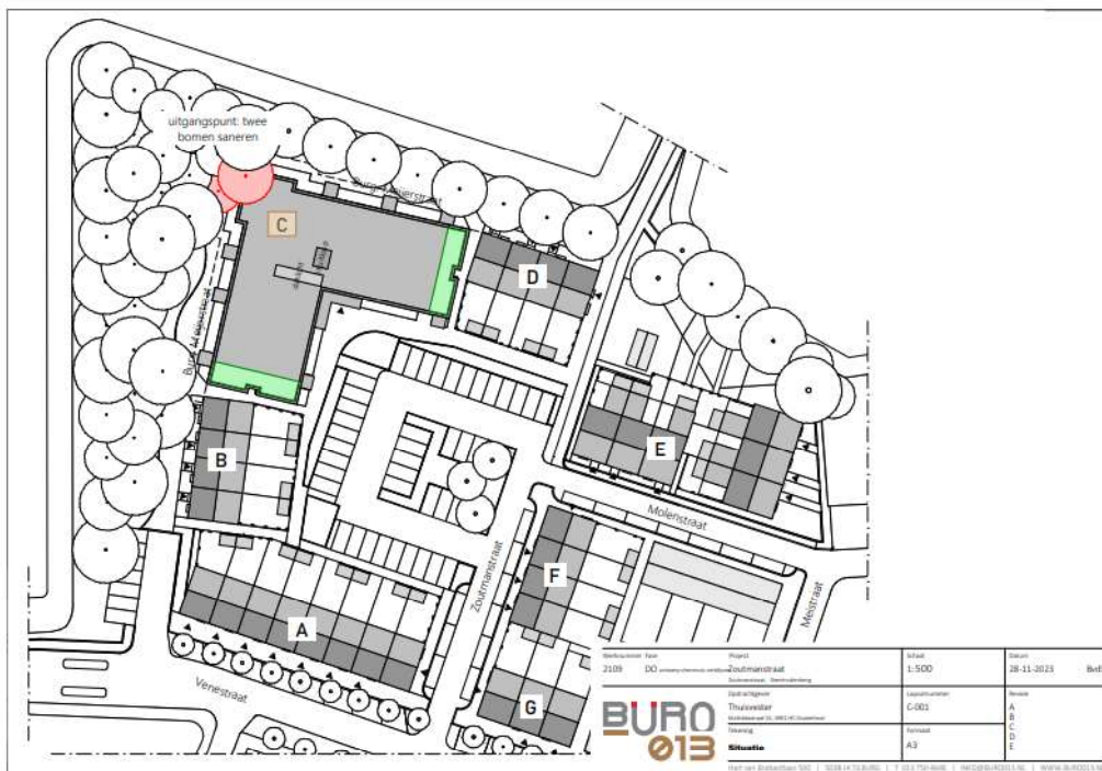
Figuur 4. Locatie van de permanente voorzieningen voor de meervleermuis. Blok c betreft het appartementencomplex met in groen gearceerd de voorzieningen. Blok g en f zijn de woonblokken waarin de satellietverblijven worden gerealiseerd.
