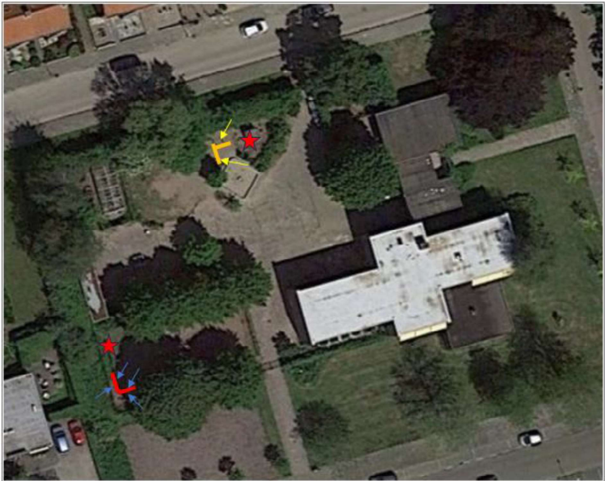
Figuur 2. Locatie van de tijdelijke voorzieningen. De rode en oranje lijnen geven aan waar de kunstgevels geplaatst worden. De blauwe en gele pijlen geven aan waar de kasten (VK SK 04) komen te hangen. De rode sterren geven de locaties weer van de te plaatsen paalkasten.
