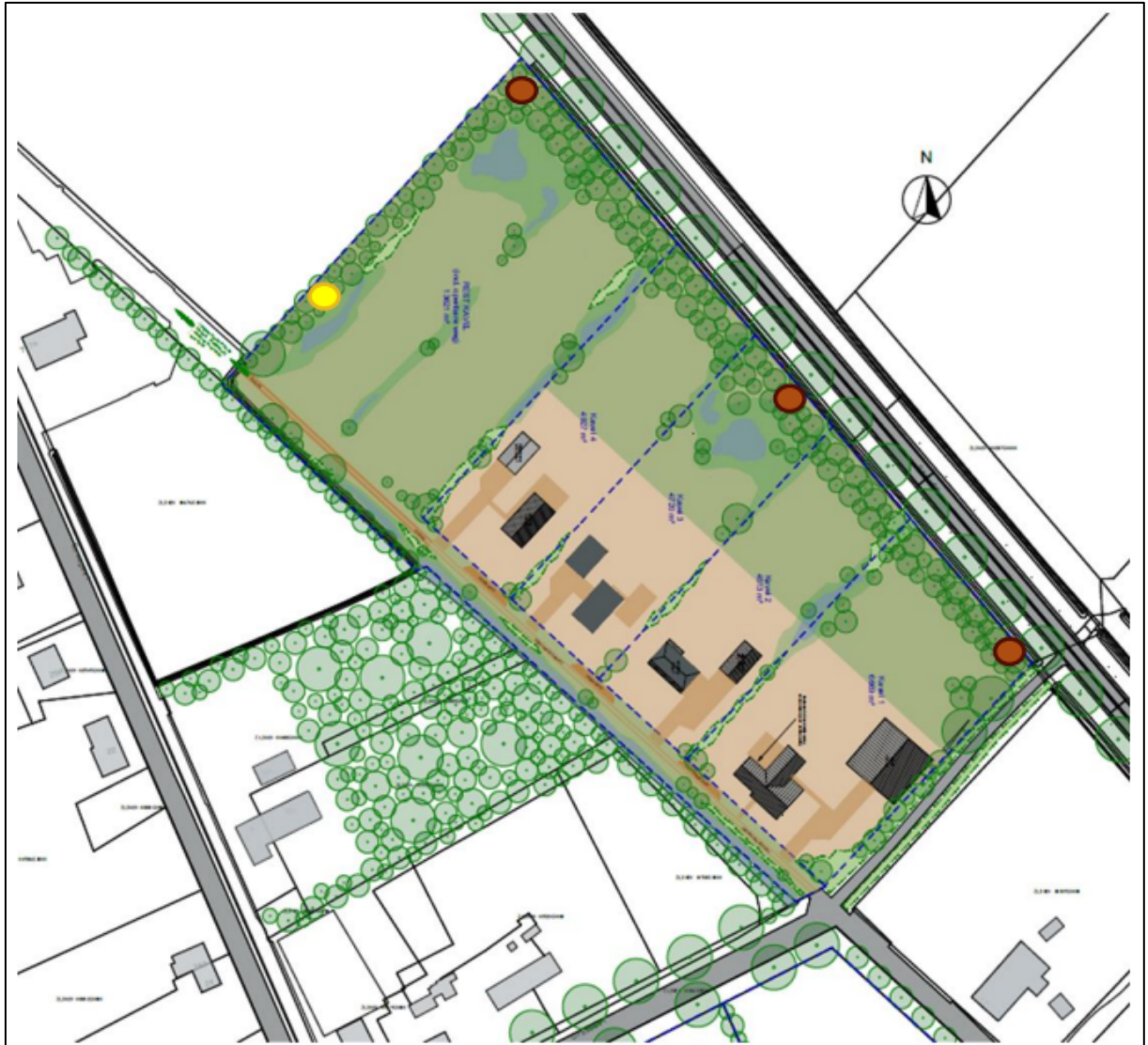
Figuur 4. De voorzieningen die voorafgaand aan de werkzaamheden worden geplaatst zijn in rood weergegeven. Nieuw te plaatsen permanente voorziening binnen gele cirkel na sloop bebouwing.
