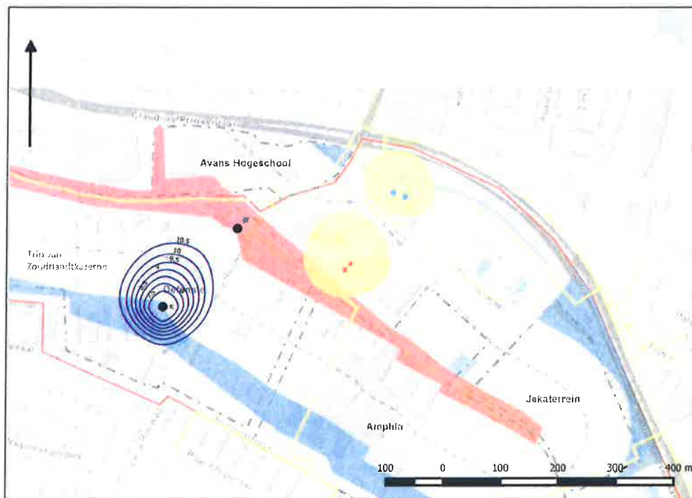
Figuur 2.6: Berekende isothermen (contourinterval 0.5 °C) einde wintersituatie na 20 jaar energieopslag Trip van Zoutlandtkazerne.
